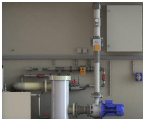
Figura 13: Ultima etapă (dispozitiv de colectare a picăturilor)
